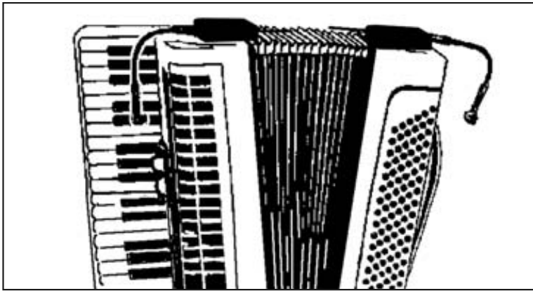
Fig. 6: Ripresa di fisarmonica con due C 516 ML
