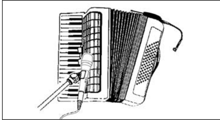
Fig. 7: Toma de acordeón con un C 516 ML y un micrófono combinado con soporte
