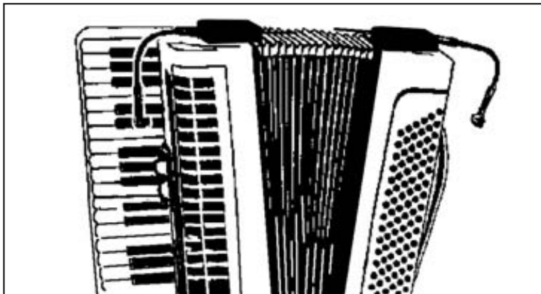
Fig. 6: Microfonar o acordeão com dois C 616 ML
