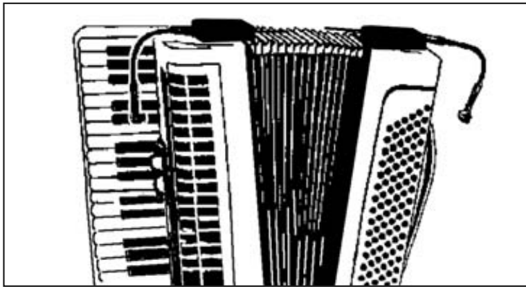
Fig. 6: Toma de acordeón con dos C 516 ML
